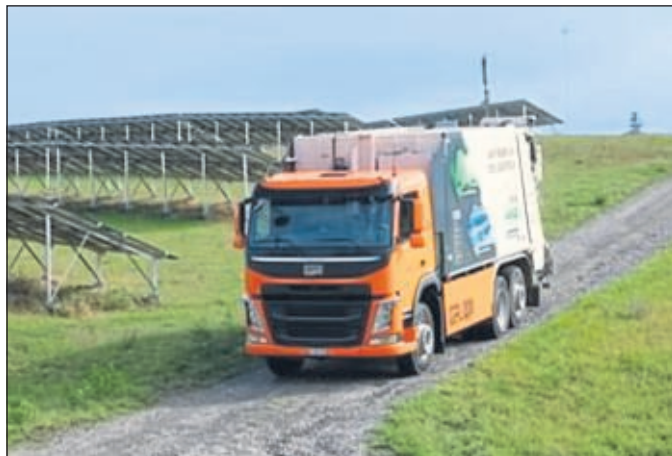
Das elektrisch angetriebene Sammelfahrzeug „Futuricum 26 E“ wiegt voll beladen 27 Tonnen und wird von vier Motoren mit insgesamt 680 PS angetrieben.
